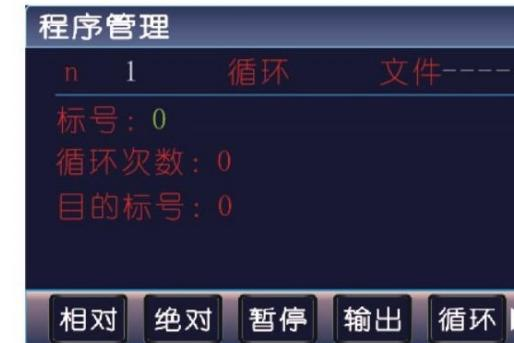
参数: 循环次数 (需要再循环的次数), 目的标号 (需要跳转到标号相同的指令处, 非行号)
