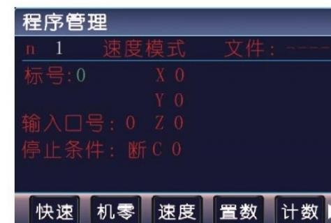
速度模式，可以让各轴以不同的速度同时运行，没有指定具体的位置值，通过输入口的状态与条件进行判断，然后选择停止，并执行下一行
