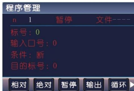
参数: 输入口号 (控制器输入口 1-16, IO 扩展板上的输入口, PLC 输入口, PLC 输入口需加前导 1, 即 1xx, 否则是前两种情况), 条件 (用来进行判断对比的条件, 通或断可选, 按切换键切换), 目的标号(检测条件不符合时,程序跳转至于标号相同的程序行处,如果此处填写为 0, 则自动向下一行执行)
