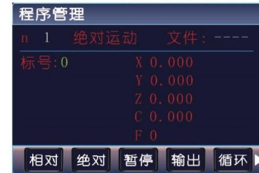
参数：X (X 向绝对坐标)，Y (Y 向绝对坐标)，Z (Z 向绝对坐标)，C (C 向绝对坐标)，F (运动速度)
