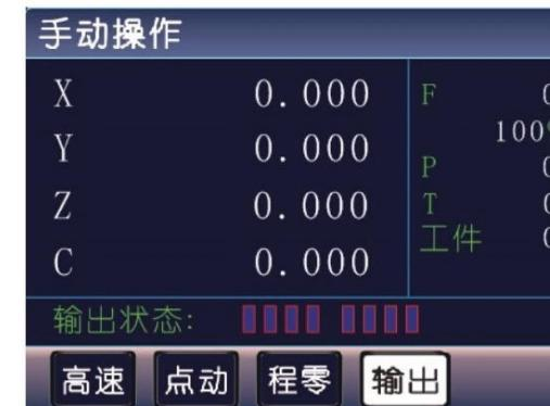
**输出:** 按输出按钮, 输出反显, 按 1~8 数字键, 可以对对应的输出口进行通断控制。
