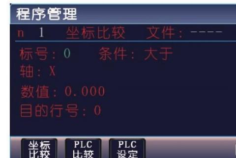
参数：条件（比较条件，用切换键切换），轴（比较的轴，按切换键切换），数值（比较的数值），目的行号（需要跳转到的行）
