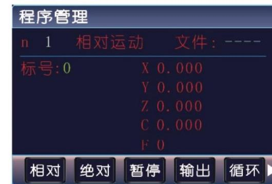
参数：参数：X (X 向运动增量)，Y (Y 向运动增量)，Z (Z 向运动增量)，C (C 向运动增量)，F (运动速度)
