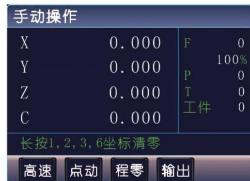
**高速:** 按高速按钮, 高速反显, 手动操作高速运行, 再按高速按钮, 高速正显, 手动操作低速运行, 在参数 - 速度中设置手动高速、手动低速。
