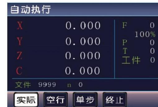
此时可通过屏幕下方的空白复用键选择相对应位置的功能进行选择操作，某功能被选中，呈反显状态。
