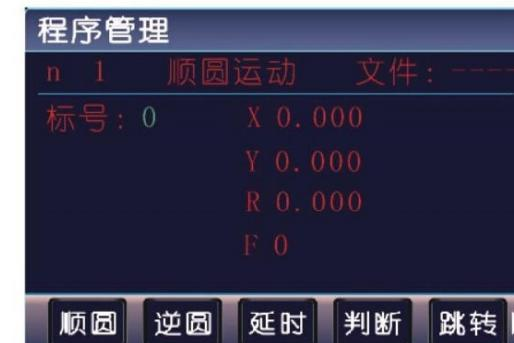
参数: X (X 向运动增量), Y (Y 向运动增量), R(圆心坐标, 圆弧为优弧即大于 0 度小于等于 180 度的圆弧时 R 值为正值, 圆弧为劣弧即大于 180 度且小于 360 度的圆弧时 R 为负值), F(运动速度)
