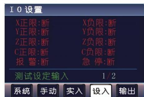
设定输入为测试用户使用系统设置中某些功能，能否正常工作，测试过程与实际输入一样，例如，测试报警，就将报警大按钮按下，正常情况下报警处由断变为通。
