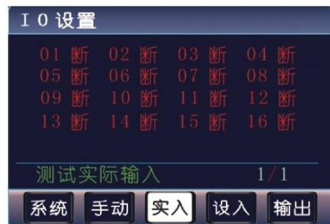
数字序号 01-16 分别对应输入口 1-16，当对应输入口信号线与 24V 地短接时，对应的位置变成“通”，否则为“断”，通过此操作可以测试输入信号是否正常
