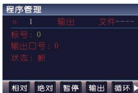
参数: 输出口号 (控制器输出口 1-8, IO 扩展板上的输出口, PLC 输出口, PLC 输出口需加前导 1, 即 1xx, 否则是前两种情况), 状态 (通或者断, 通过切换键切换)
