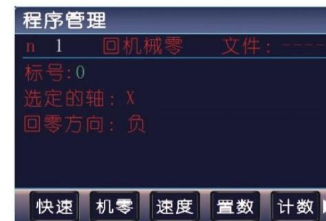
参数：选定的轴（单轴默认为 X，多轴 X/Y/Z/C 可通过切换键切换），回零方向（回零的方向正负可通过切换键切换）
